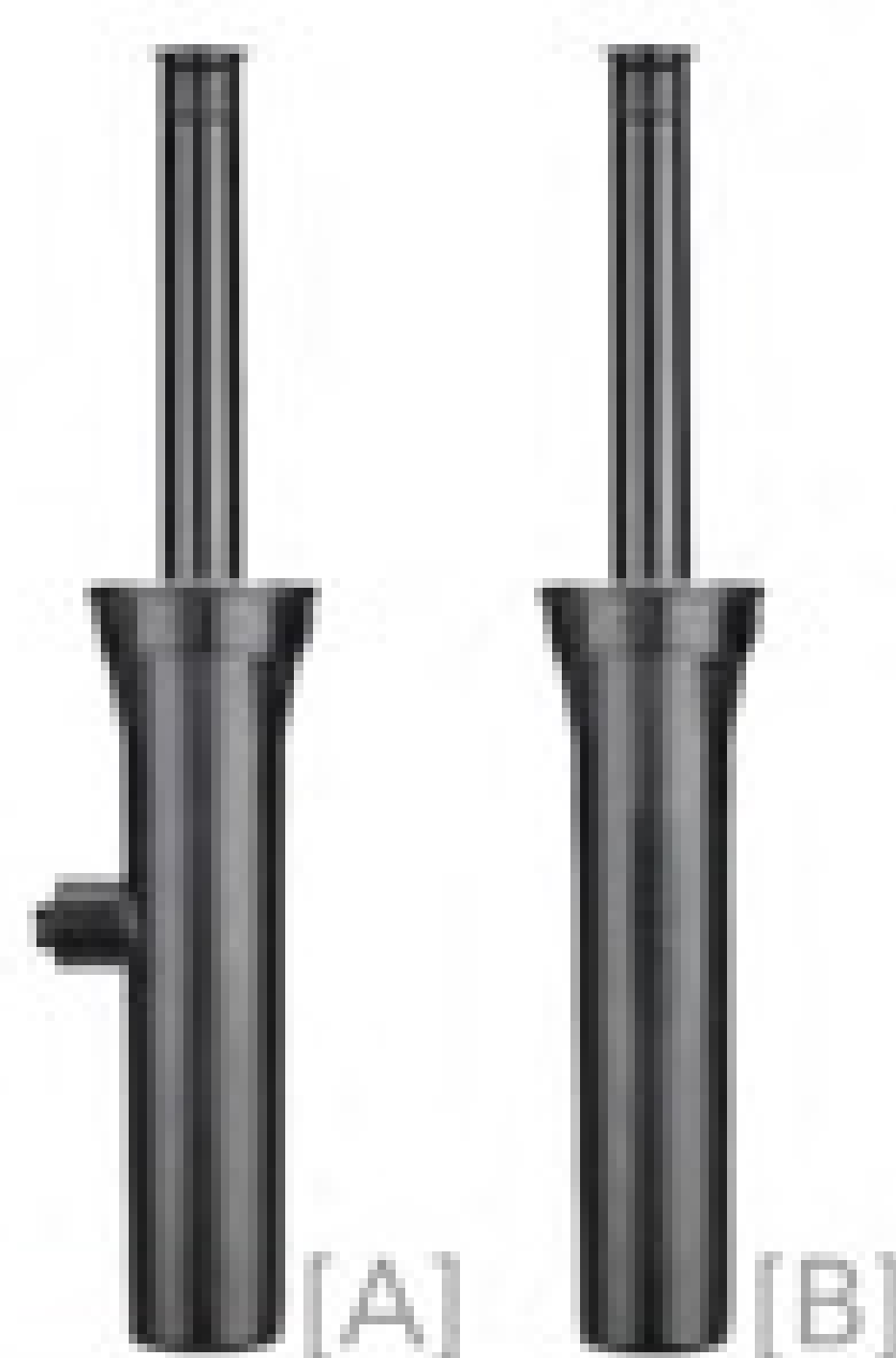
[A] PROS-06 [B] PROS-06-NSI Całkowita wysokość po wsunięciu: 22,5 cm Część wynurzalna: 15 cm Średnica zewnętrzna: 5,7 cm Rozmiar wejścia: 1/2"
